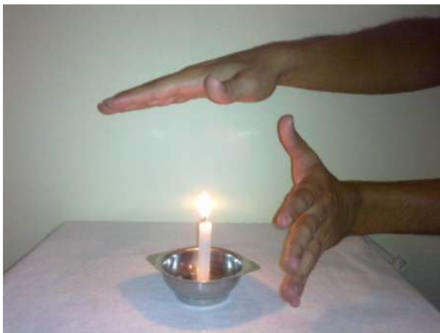
Figura 1 – Percepção da intensidade de calor em posições distintas. (Foto do autor).
