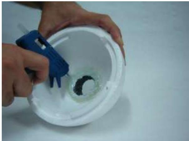
Figura 5: Fixando a lente a bola de isopor.
